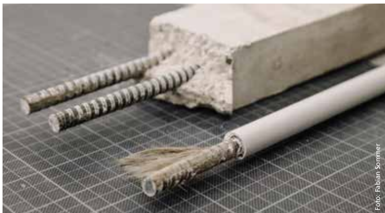
Basaltstäbe als Bewehrung im Beton: Als ganzer Stab und aufgedreht in Einzelfasern.
