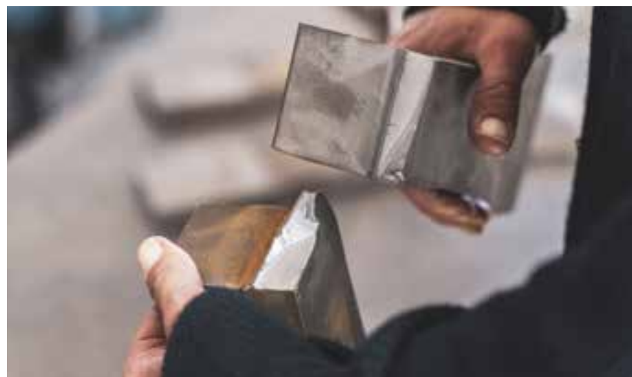
Bei dieser Bruchfläche prüfen die HM-Forscherinnen und Forscher, ob es einen speziellen Grund für die Rissentstehung gibt – z. B. Unregelmäßigkeiten im Werkstoff oder einen Fertigungseinfluss
