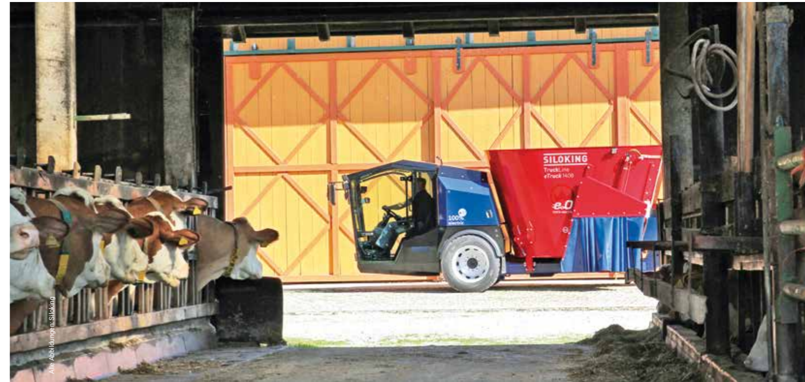
Vollelektrischer Selbstfahrer-Futtermischwagen (SILOKING eTruck)
