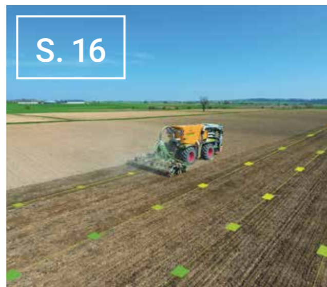
Selbstfahrer zur teilschlagspezifischen Ausbringung und Einarbeitung von Gülle-Grunddüngung
