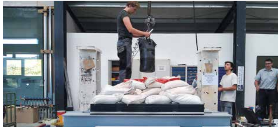
Belastungsversuche an Verbundglaselementen: ein Forschungsprojekt des Instituts für Material- und Bauforschung.
