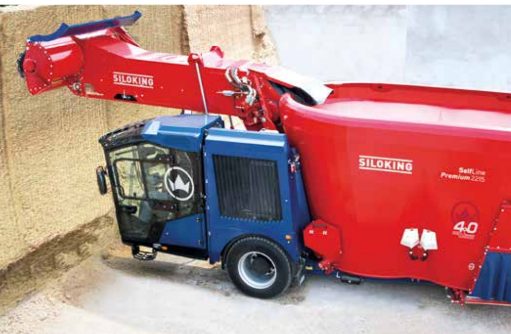
Selbstfahrer-Futtermischwagen bei der Selbstbefüllung am Maissilo (SILOKING SelfLine 4.0)
