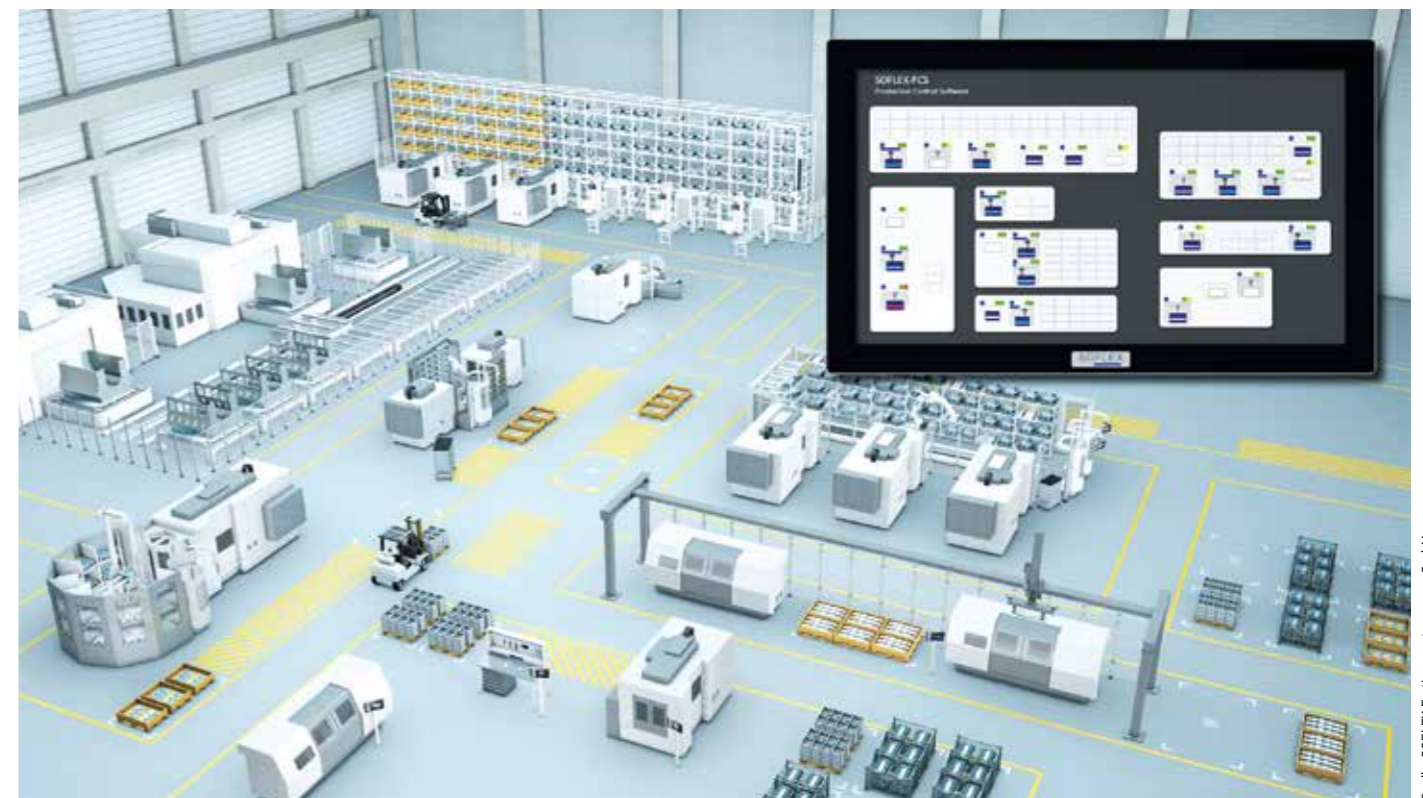
Leitsystemsoftware organisiert, steuert und visualisiert einen automatisierten Produktionsbereich
