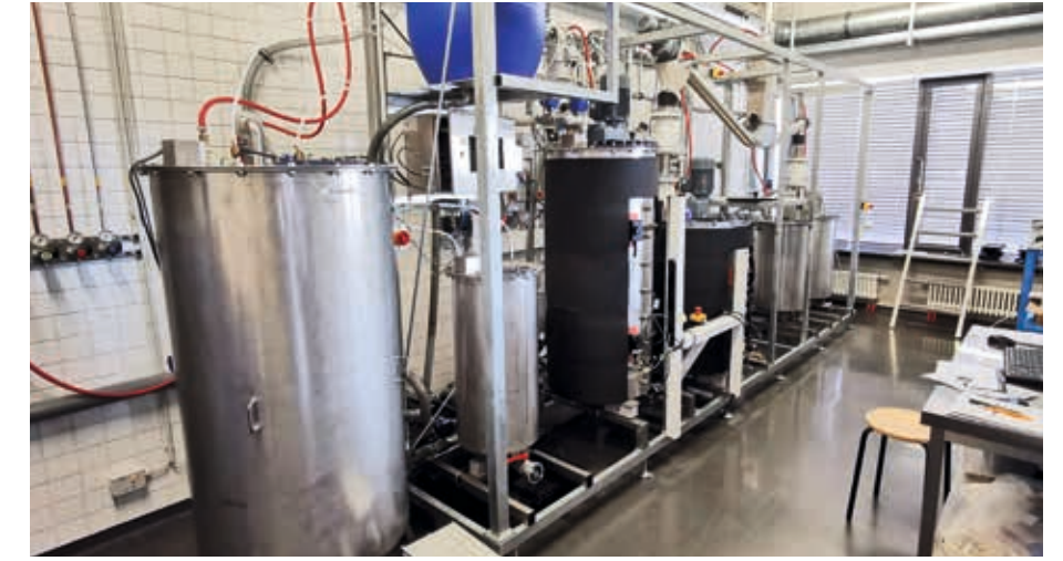
Laborbiogasanlage der THI, an der die Methanisierungsverfahren unter möglichst realen Bedingungen wissenschaftlich untersucht werden. An der FAU werden hierzu die beiden unterschiedlichen Reaktoren zur Methanherstellung entwickelt. Als Industriepartner ist die Firma regineering GmbH aus Denkendorf an beiden Forschungsprojekten beteiligt.
