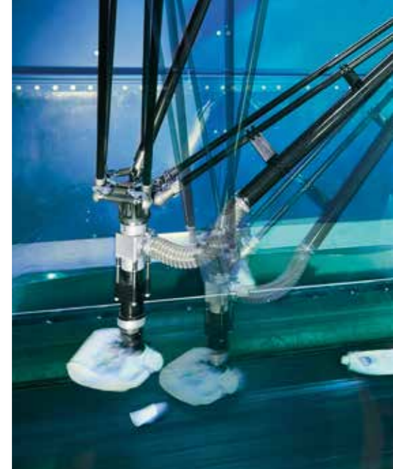
Der Sortierroboter wurde angeleitet, um dank künstlicher Intelligenz wesentlich effizienter als zuvor, Materialien auch nach Form und Farbe zu sortieren
