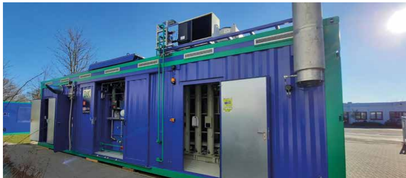
Abb. 1: Biogasreformer zur Erzeugung von Grünem Wasserstoff aus Reststoffen wie Gülle und Mist
