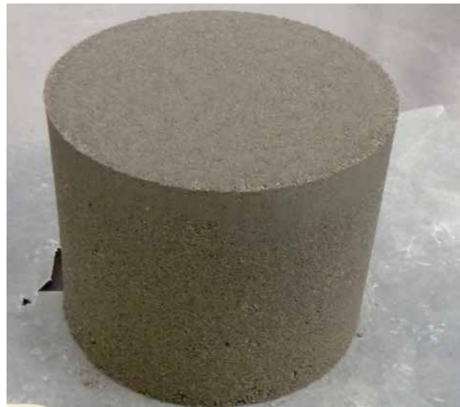
Abb. 1: Procter einer Mischung mit 100 % Ersatz von Sand und Kies durch LD-Schlacke der Körnung 0/8
