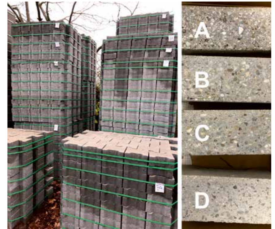
Abb. 2: links: produzierte Pflastersteine im Werk, rechts: Pflastersteine mit verschiedenen Anteilen an Asche bzw. Schlacke A: 100 % Ersatz der Körnung 0/8 durch Asche B: Referenzstein mit natürlicher Gesteinskörnung 0/8 C: 50 % Ersatz der Körnung 0/8 durch Schlacke D: 100 % Ersatz der Körnung 0/8 durch Schlacke
