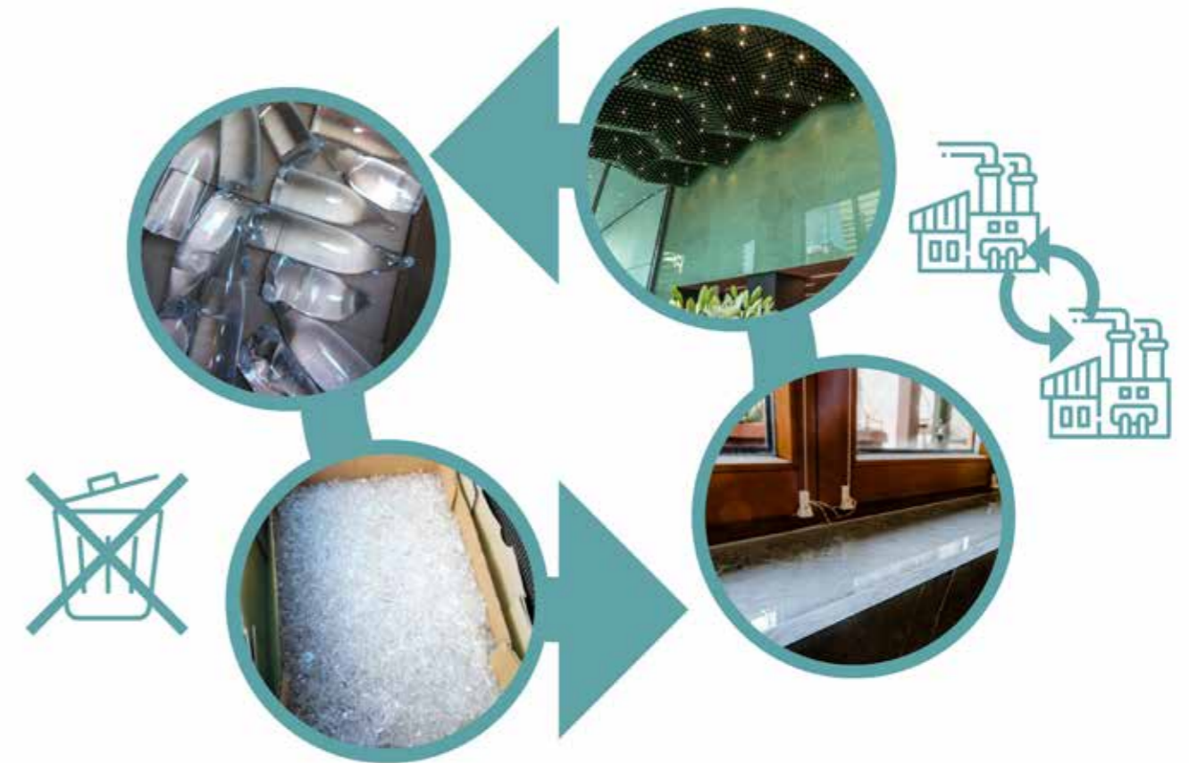
Projektbeispiel: Nicht recycelbares Glas wird zu Glaskeramik. Diese kann am Lebenszyklusende wieder eingeschmolzen werden
