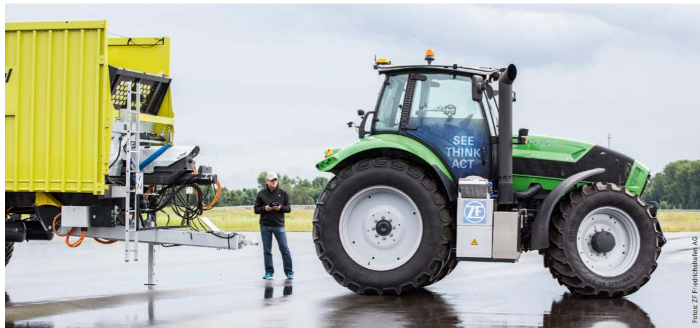
Den Weg weisen: Der ZF Innovations-Traktor lässt sich mittels eines Tablets mühelos von außerhalb der Fahrerkabine dank stufenloser Getriebetechnik feinfühlig in jede gewünschte Position steuern. Besonders hilfreich ist die Funktion beim Rangieren mit zwei Mehrachsanhängern
