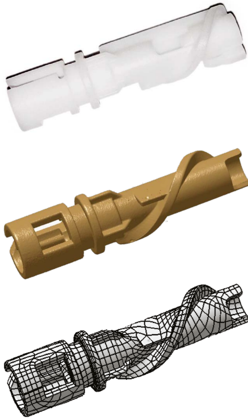
CT-Aufnahme des Bauteiles Oben: reales Bauteil aus Baugruppe Mitte: CT-Aufnahme des Bauteils Unten: CAD-Volumenkörper basierend auf der CT-Aufnahme
