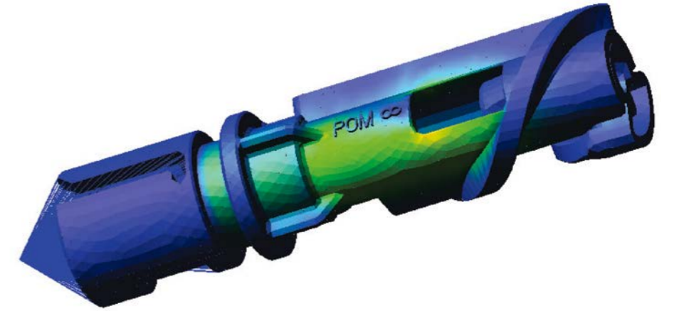
FE-Ergebnisse für das ausgewählte Bauteil der Baugruppe
