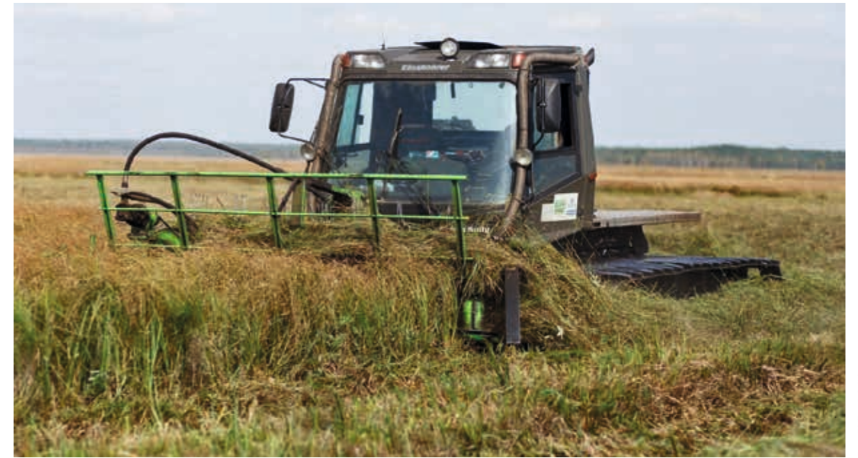
Ernte einer Nasswiese im Niedermoor mit kettenbasierter Spezialtechnik: die große Auflagefläche verursacht nur geringen Bodendruck
