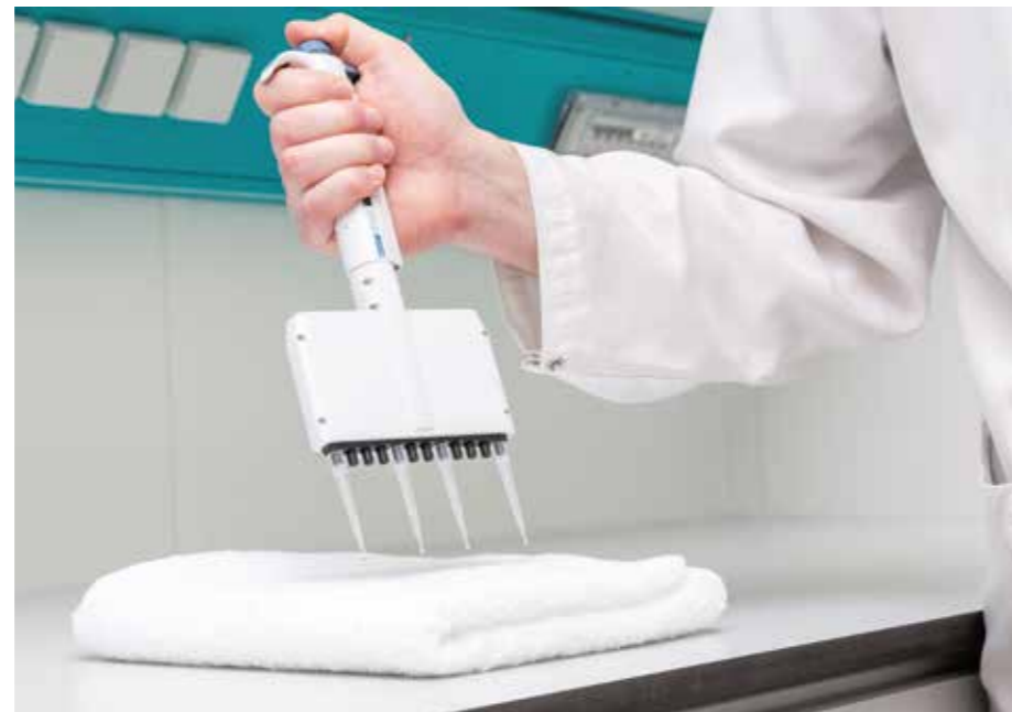
Chemiker von WACKER prüfen mit Benetzungstests die Saugfähigkeit von Frotteegeweben, die mit Siliconweichmachern ausgerüstet sind
