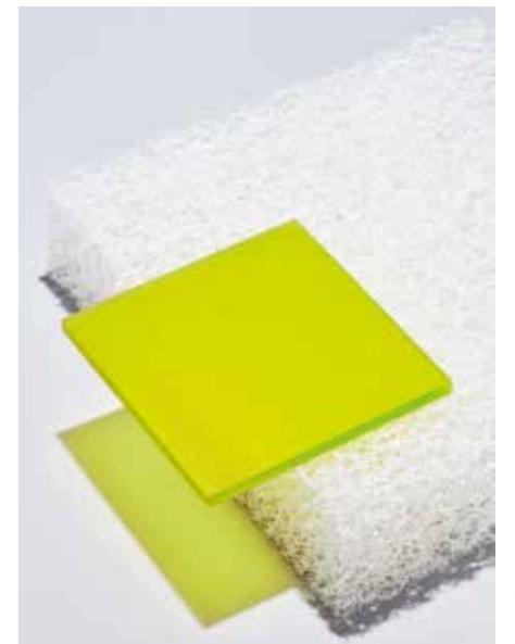
Schlaufenstruktur aus Endlofasern
