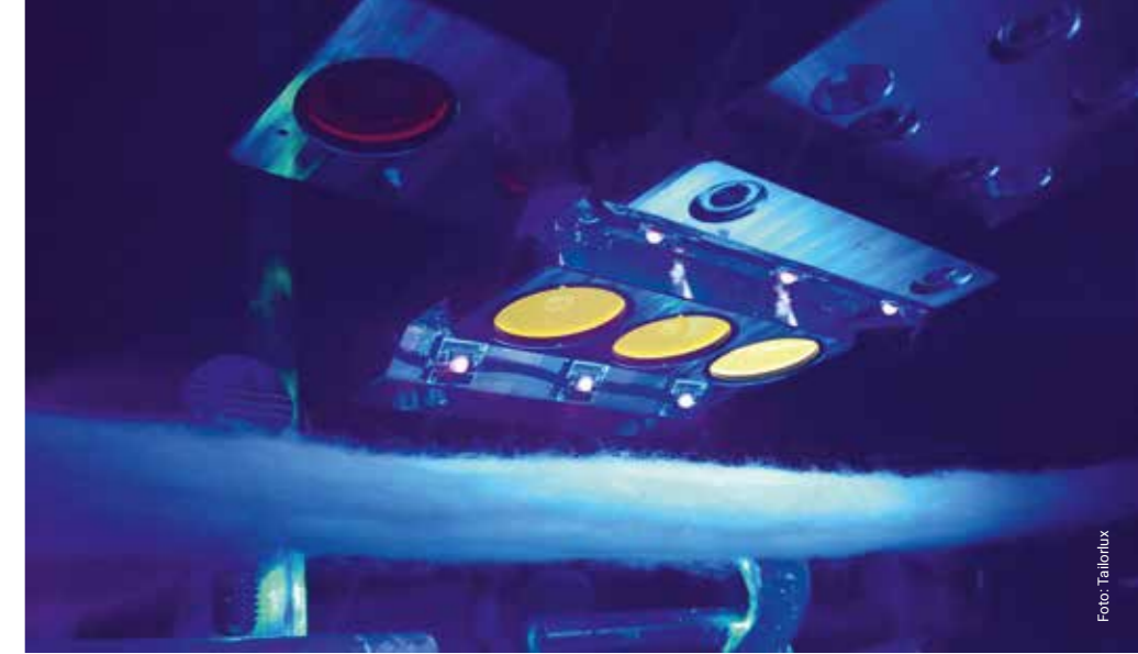
Identifizierung des Tailorlux-Fluoreszenzmarkers mit UV-Blitzlicht
