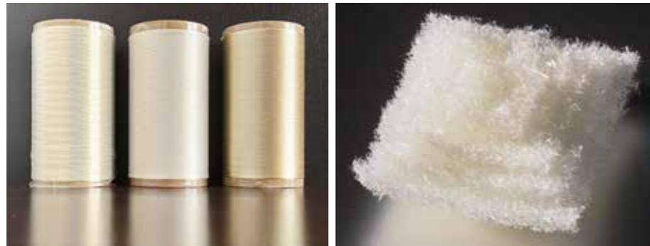
Abb. 1: (links) Multifilamentgarne aus dem Biopolymer Chitosan; (rechts) mittels FAM-Technologie hergestelltes Chitosan-Scaffold als Knochenimplantat
