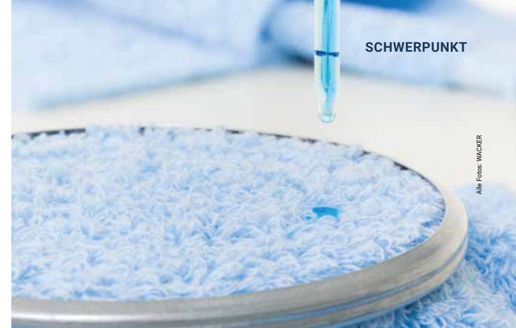
Zur Bestimmung der Hydrophilie wird das mit einem Siliconweichmacher ausgerüstete Textilgewebe mit einem Tropfen salzfreies Wasser benetzt. Anschließend wird die Zeit gemessen, bis der Tropfen vollständig aufgesogen ist. Je schneller der Tropfen einsinkt, desto effektiver unterstützt das Silicon die Saugfähigkeit des Gewebes
