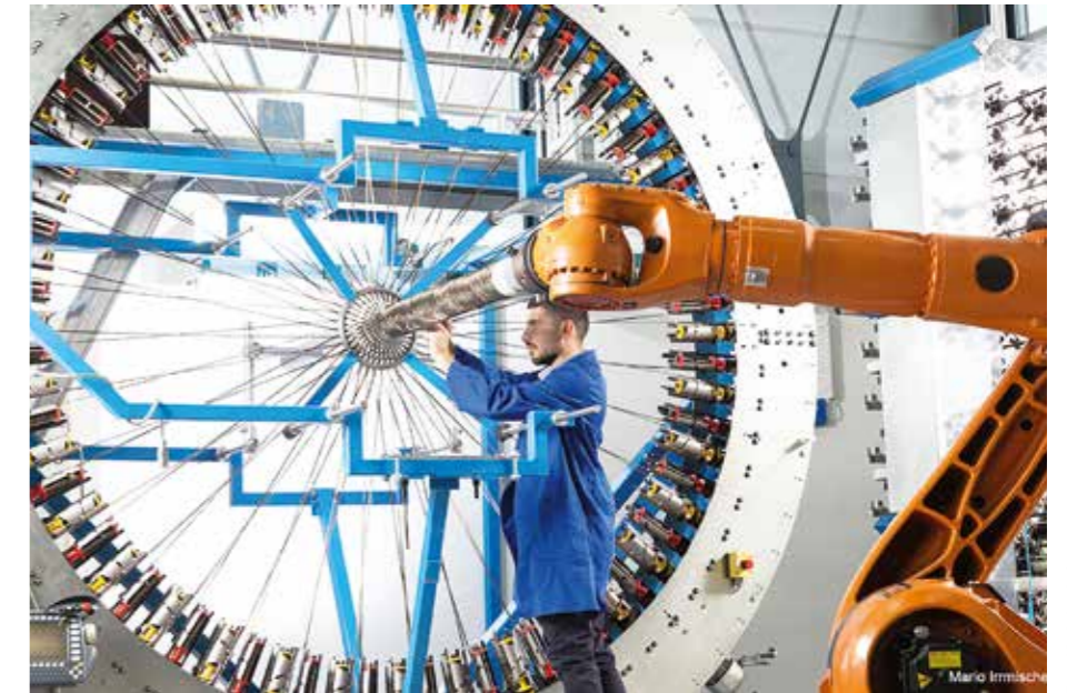
Flechten einer Faserverbundstruktur
