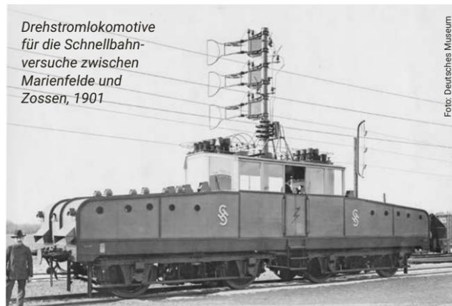
Drehstromlokomotive für die Schnellbahnversuche zwischen Marienfelde und Zossen, 1901
