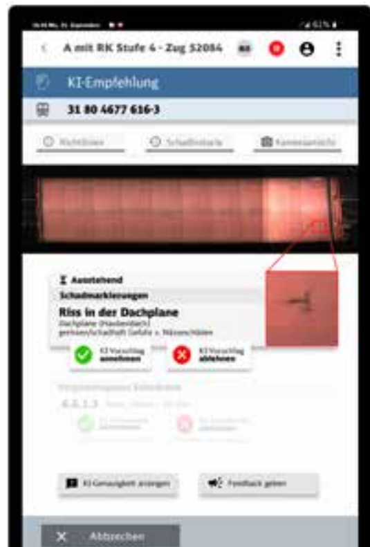
Automatische Detektion eines Risses der Dachplane und dessen zukünftige Darstellung auf dem Tablet des Wagenmeisters
