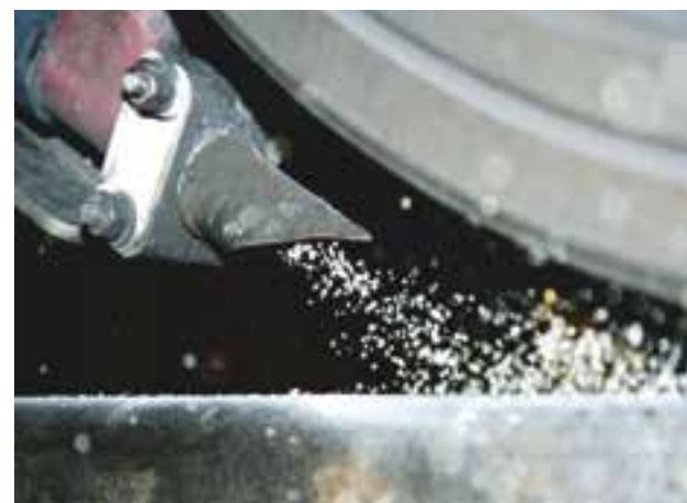
Abb. 1: Ein situationsangepasstes Sandungsmanagement regelt zugweit die Sandausbringung
