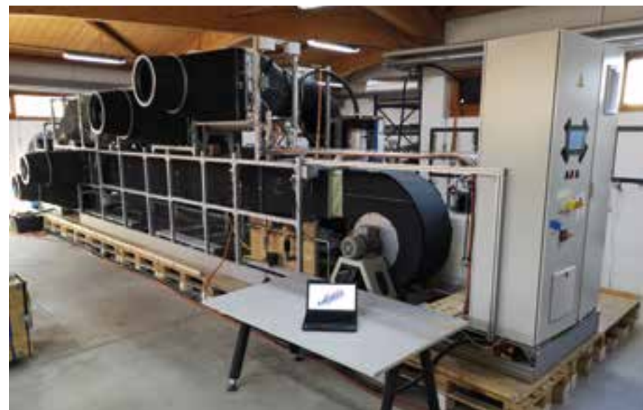
Im Münchner Prüflabor der DB Systemtechnik werden Kompaktklimageräte getestet
