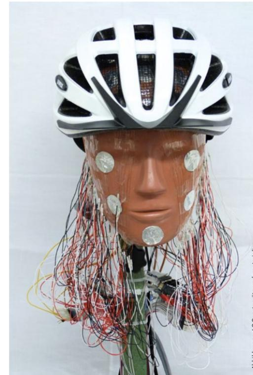
Abb. 2: Kopf-Modell mit speziellem Heizsystem zur Entwicklung von Kühlsystemen für Helme
