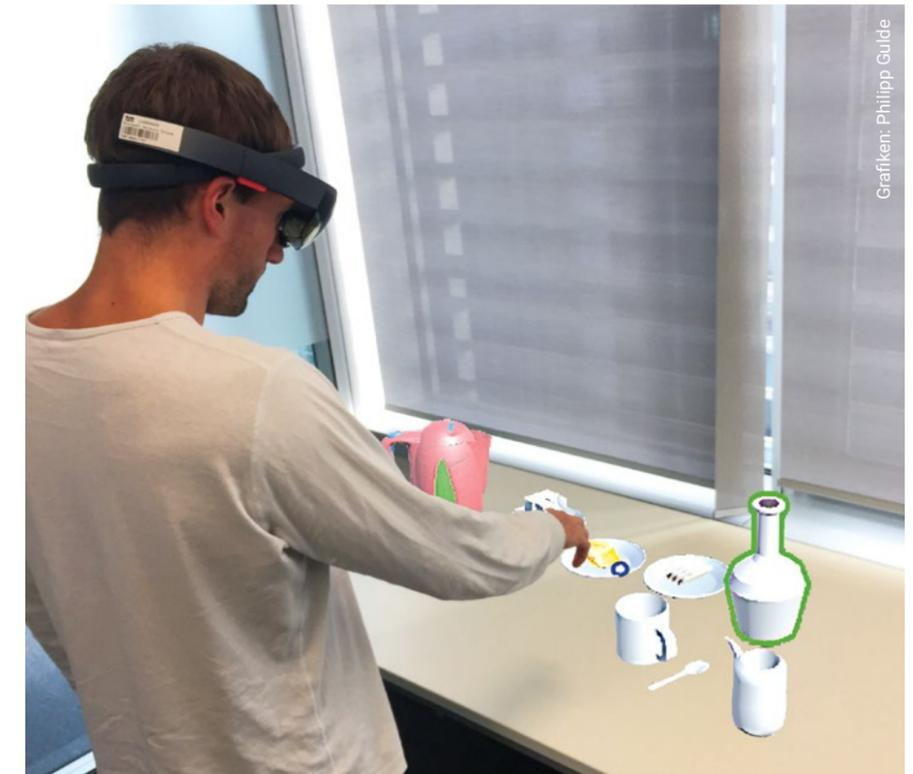
Entwickler mit einer HoloLens beim Validieren einer AR Applikation. Alle Objekte auf der Tischfläche sind eingblendete Hologramme.
