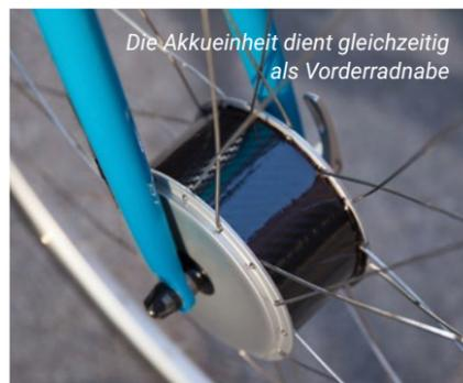
Die Akkueinheit dient gleichzeitig als Vorderradnabe
