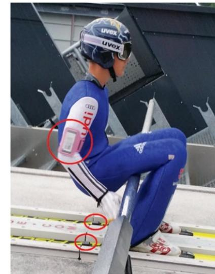
Inertialsensoren (IMU) und Kraftmesssohlen
