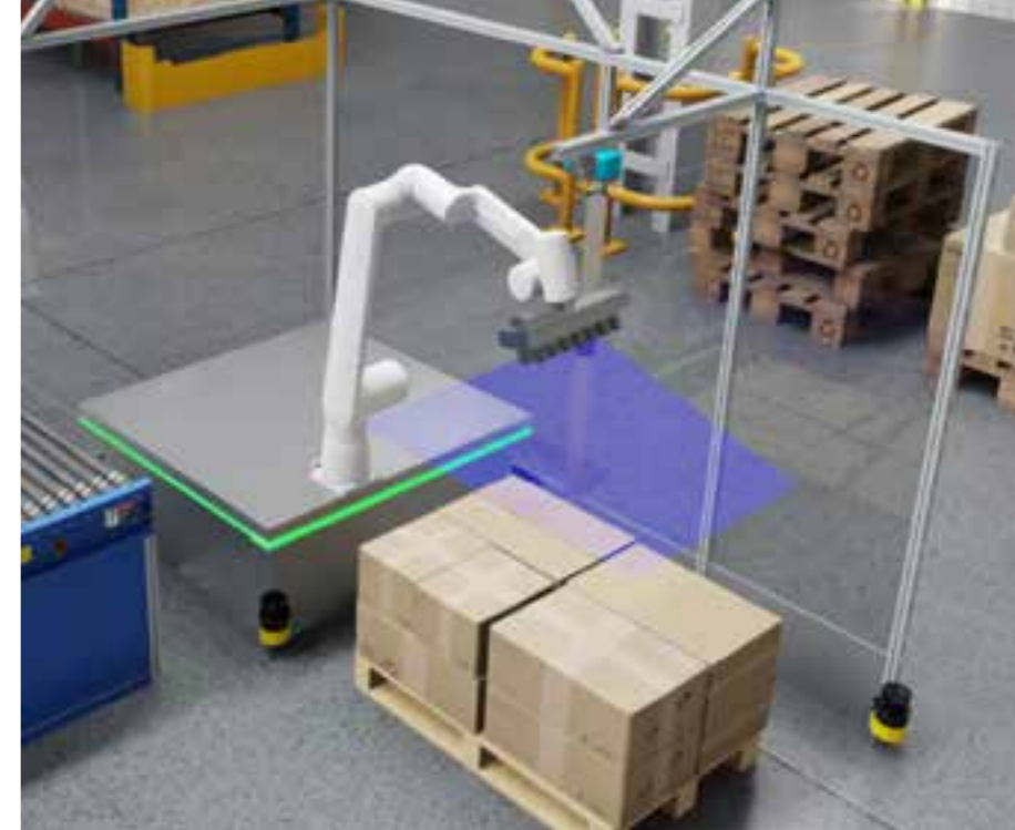
Mit Hilfe einer Simulation lassen sich beispielsweise Sensoren in unterschiedlichen Anschluss- und Schnittstellenversionen als 3D-Modelle anzeigen oder direkt in virtuelle Montagesituationen von Maschinen integrieren, in ihrer Funktionsfähigkeit testen und in ihrem Arbeitsabstand oder ihrer Ausrichtung optimieren
