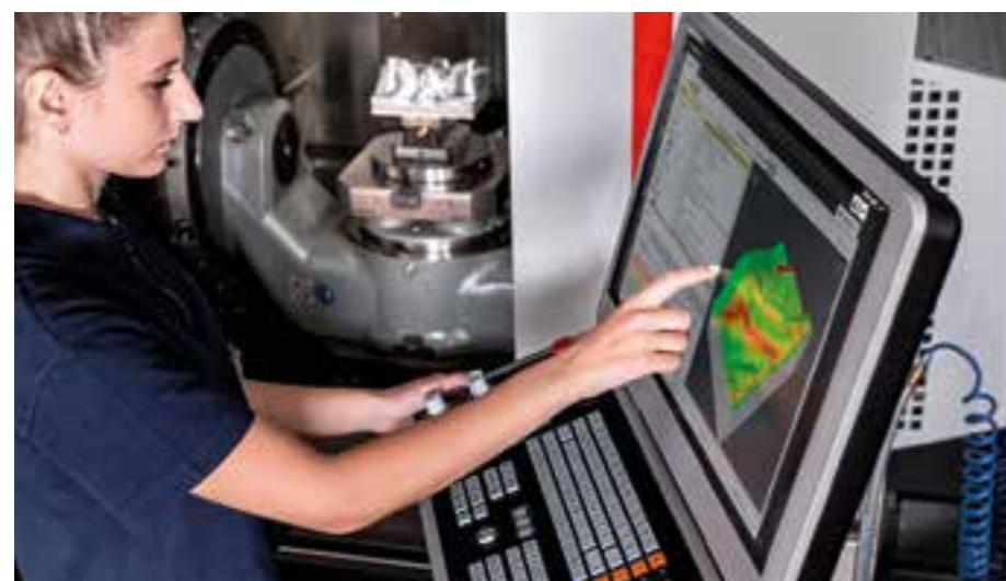
Die TNC Komponentenüberwachung zeigt kritische Genauigkeitsabweichungen der Maschine frühzeitig an und ermöglicht effiziente Wartungs- und Service-Einsätze
