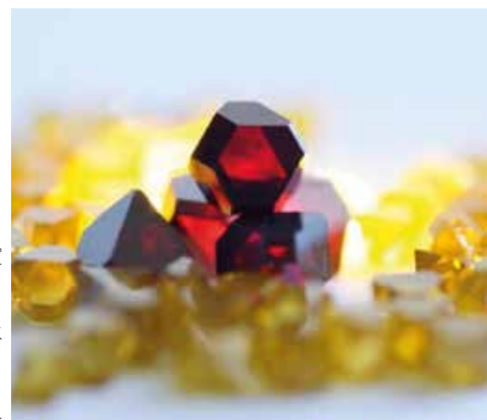
Diamantkristalle mit hoher Dichte an NV-Zentren mit typisch roter Farbe
