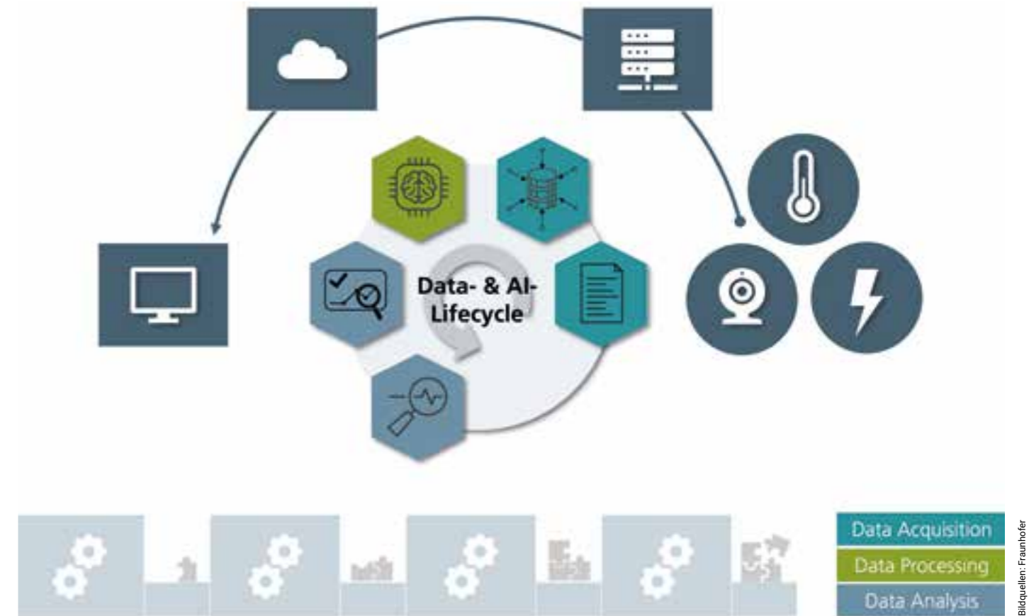
Beispielhafter Daten- & KI-Lebenszyklus bestehend aus fünf KI-Services (Sechsecke) – Datenerhebung, Datenaggregation, KI-Training, KI-Analyse, KI-Monitoring – der flexibel im Edge-Cloud-Continuum verteilt ist
