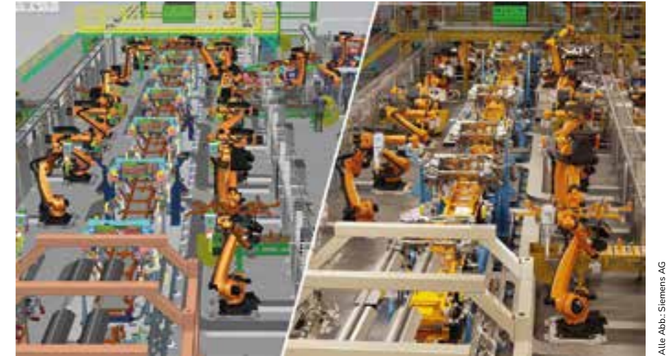
Siemens Process Simulate (links) ist mit NVIDIA Omniverse (rechts) verbunden, um einen fotorealistischen, digitalen Zwilling mit voller Designtreue in Echtzeit zu ermöglichen
