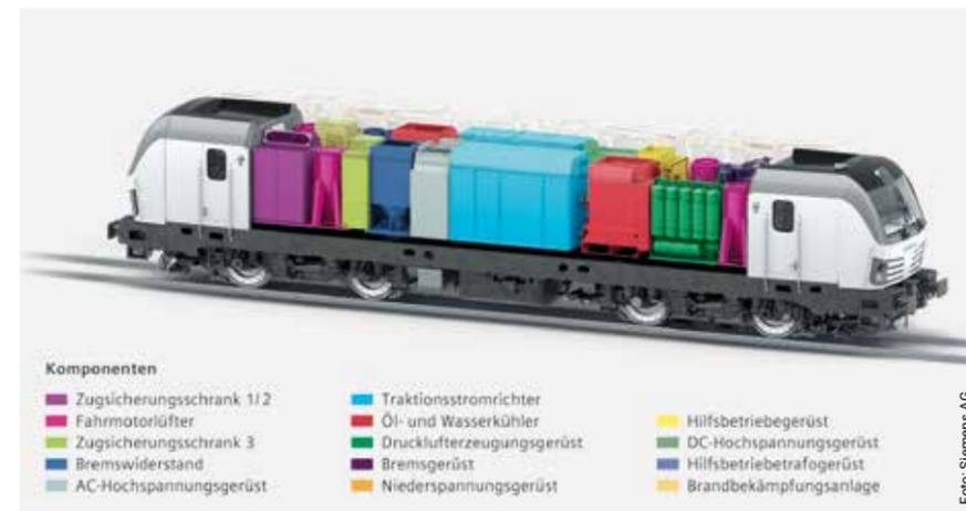
Anordnung der Komponenten in einem Mehrsystem-Vectron
