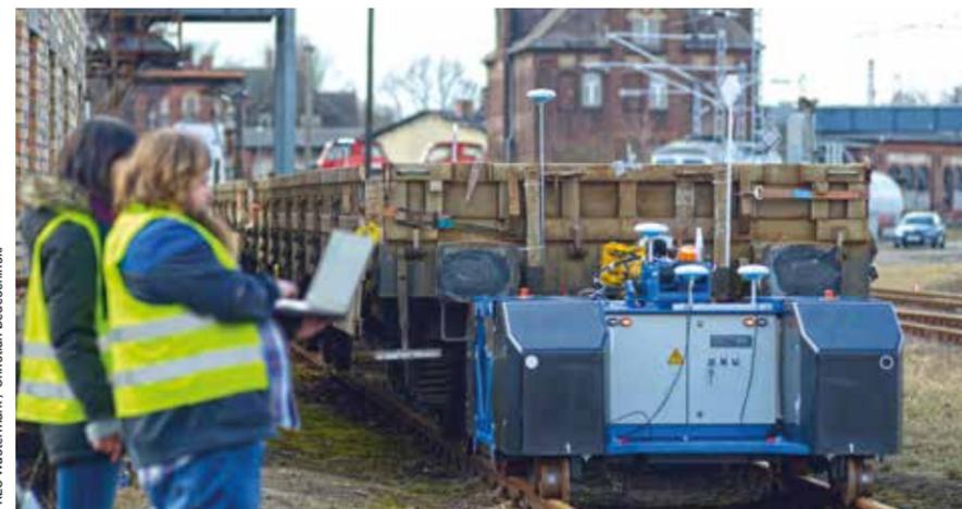
Abb. 1: Automatisierter Elektro-rangierer im Projekt Galileo Online: GO!
