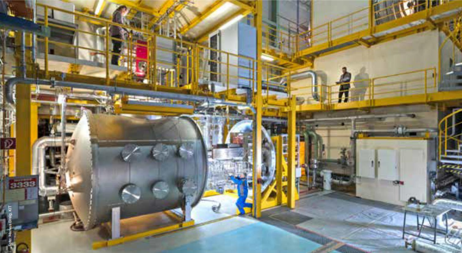
Der Hochdruck/Hochtemperatur-Helium-Versuchskreislauf HELOKA am KIT
